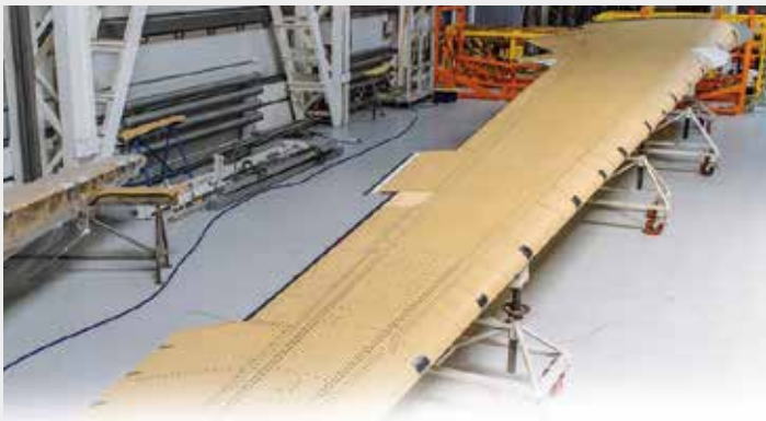
КЕССОН КРЫЛА МС-21 ИЗ РОССИЙСКИХ КОМПОЗИТОВ УСПЕШНО ПРОШЕЛ ИСПЫТАНИЯ НА ПРОЧНОСТЬ
